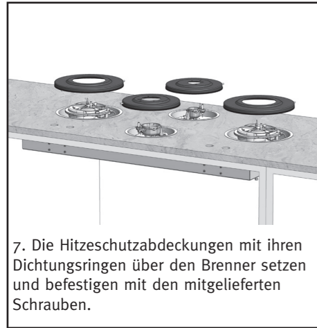
8. Die 2- und 3 kW Hitzeschutzabdeckung kann nur auf eine Weise platziert werden. Sie sind jeweils mit zwei Schrauben befestigt.
