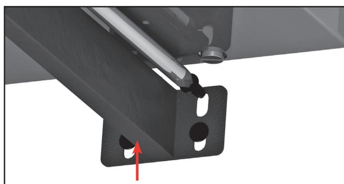
6. Empuje las ménsulas firmemente contra la parte inferior de la unidad PITT® cooking y apriete firmemente los dos tornillos superiores y luego los tornillos inferiores.
