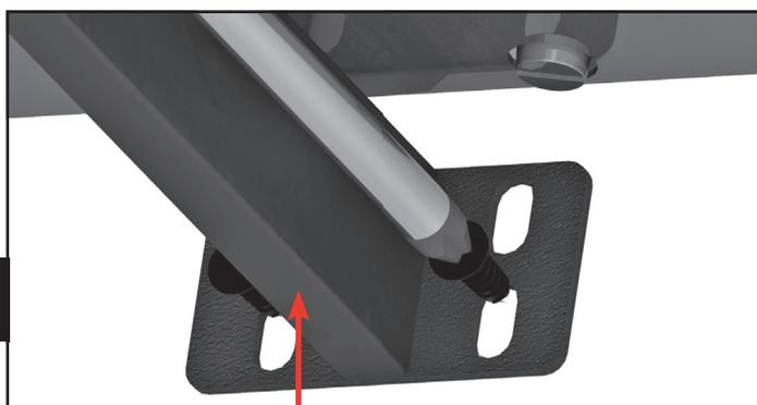
5. Empuje las ménsulas firmemente contra la parte inferior de la unidad PITT® cooking y apriete a mano los dos tornillos inferiores. Repita este paso en el otro extremo del mueble.
